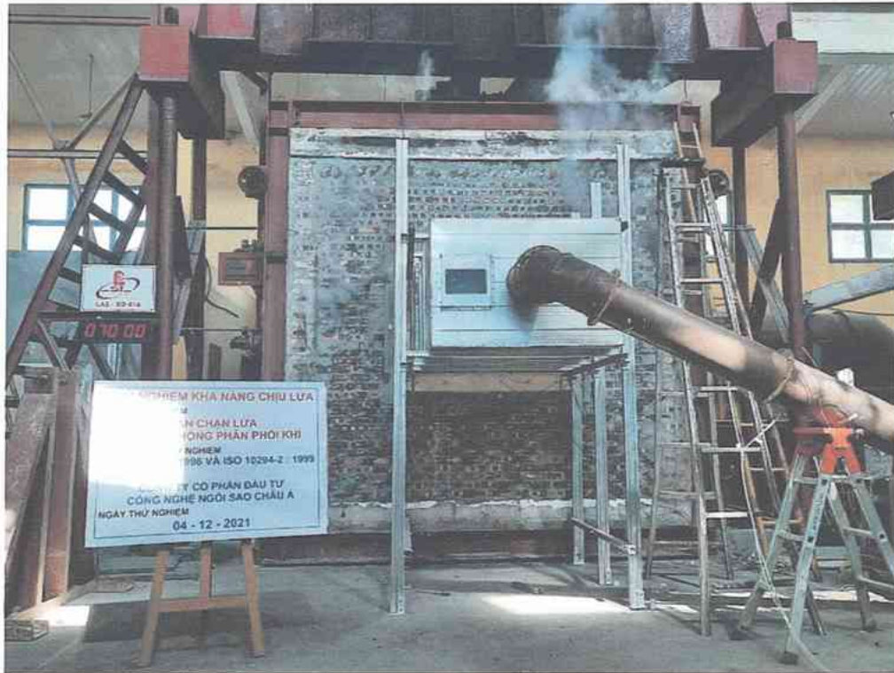
Ảnh D.7: Mẫu thử tại phút thứ 70 của quá trình thử nghiệm
